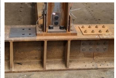
(d) Col E Pinned Base Detail
